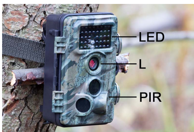
รูปที่ 2.7.2.2: กล้องถ่ายภาพพร้อมระบบตรวจจับการเคลื่อนไหวแบบ PIR
