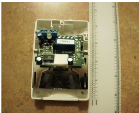
รูปที่ 2.7.9.2: ถอดฝาครอบออกแล้ว กระจกแบ่งส่วน ด้านล่างมีแผงวงจรพิมพ์ (PC) อยู่ด้านบน
