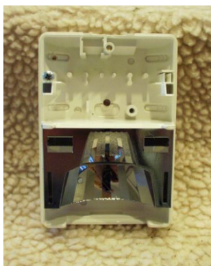
รูปที่ 2.7.9.3: แผงวงจรพิมพ์ถูกถอดออกเพื่อแสดงกระจกแบบแบ่งส่วน
