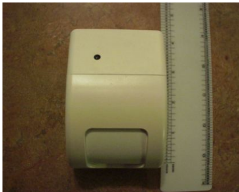
รูปที่ 2.7.9.1: PID ทัวไปสำหรับที่พักอาศัย/เชิงพาณิชย์ที่ใช้กระจกแบ่งส่วนภายในเพื่อการโฟกัส
