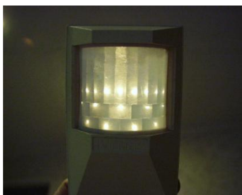
รูปที่ 2.7.8.2: ฝาครอบด้านหน้า PIR เท่านั้น (ถอดอุปกรณ์อิเล็กทรอนิกส์ออก) โดยมีแหล่งกำเนิดแสงจุดอยู่ด้านหลัง เพื่อแสดงเลนส์แต่ละตัว
